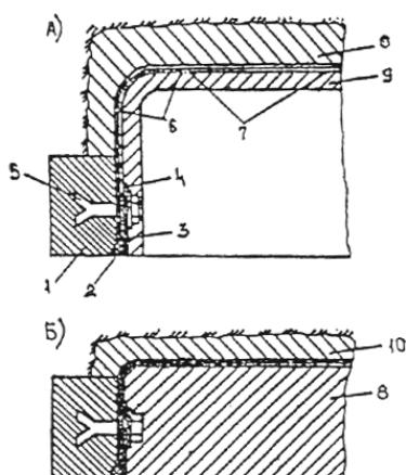
сопряжение сборной обделки из чугунных тюбингов со сборной обделкой из железобетонных водонепроницаемых блоков (см. рис. 11) с обязательной заделкой в бетон блоков анкерных болтов применением в плоскости сопрягаемых поверхностей мастики гидроизомаст (табл. 1) и заполнением канавки расширяющимся самоуплотняющим вяжущим (БУС, БРЦ и др.) оформление проема в тюбинговой обделке тоннеля при наличии перевязки швов в ней (см. рис. 12);
