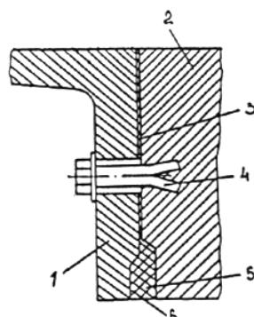
Рис. 11. Схема сопряжения сборной тюбинговой обделки со сборной обделкой из железобетонных блоков для закрытого способа строительства тоннелей:
