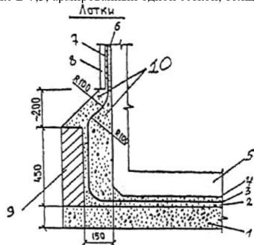
Рис. 5. Конструкция гидроизоляции лотка и нижней части стен:
