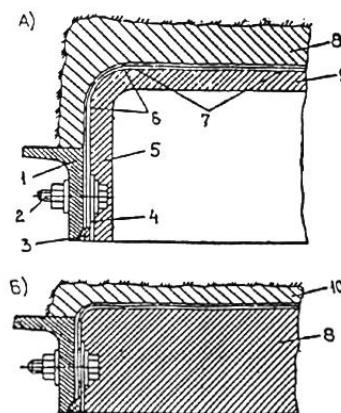
Рис. 9. Схема сопряжения монолитной бетонной и тюбинговой обделок:
