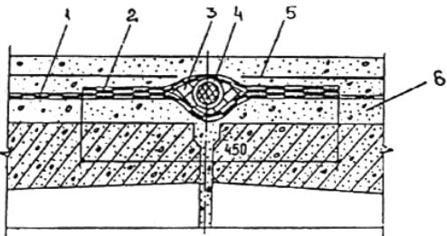
Рис. 17. Конструкция гидроизоляции деформационного шва между плитами перекрытия:
