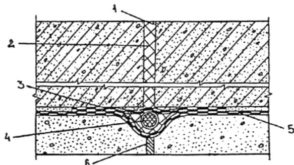
Рис. 15. Конструкция гидроизоляции деформационного шва в монолитном лотке:
