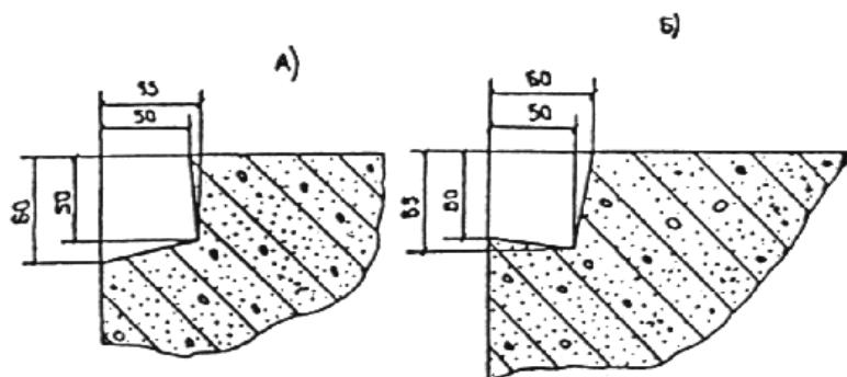
Рис. 7. Конструкция чеканочных канавок:
