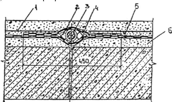
Рис. 18. Конструкция гидроизоляции деформационного шва между прогонами:
